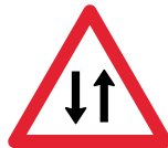
1.26 Circulation en sens inverse (Annonce au conducteur qu'il doit s'attendre à des véhicules venant en sens inverse)
